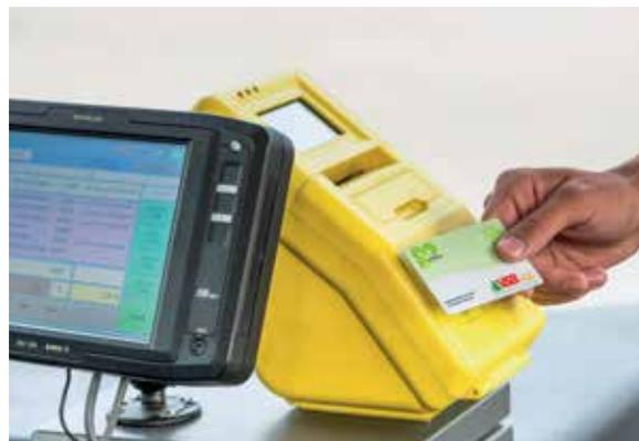
Bild 8: Elektronisches Ticketing-Verkaufssystem im Bus
